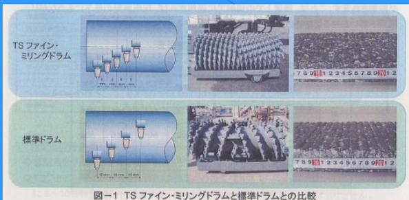
図-1 TSファイン・ミリングドラムと標準ドラムとの比較
